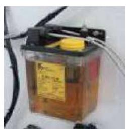
Sistema di lubrificazione assi automatica centralizzata gestita dal CN.
